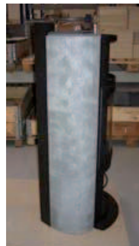
15. Seitenkacheln montiert – bitte auf die Höhe achten.
