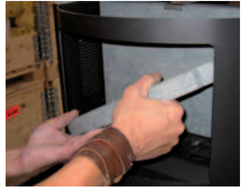
22. Montage der Bodenplatte im Warmhaltefach.
