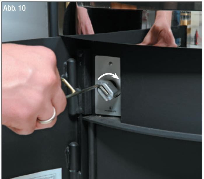
Sind auch diese Holzscheite rundherum angebrannt, sollten Ofen und Abgassystem weitgehend die Betriebstemperatur erreicht haben. Jetzt können Sie die Primärluft-Einstelleinrichtung (links) im Uhrzeigersinn auf "MIN" stellen (Abb. 10) und die Verbrennung hauptsächlich über die Sekundärluft-Einstelleinrichtung (rechts) regeln. Die Anheizeinrichtung kann geschlossen werden.
