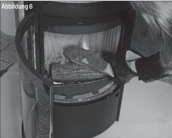
Je nach Holzgüte, Schornsteinzug und Witterung dauert diese Verbrennungsphase unterschiedlich lange. Legen Sie jetzt zwei weitere Holzscheite parallel zur Feuerraumscheibe auf und verschließen die Feuerraumtür (Abb. 6).
